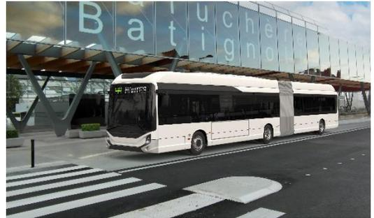
Ils sont dotés du moteur électrique SIEMENS Elfa III qui offre 310 kW de puissance maximale (3000 Nm) sur la version standard et 375 kW (4000 Nm) sur la version articulée. Pour un confort thermique amélioré, les GX ELEC disposent d'une pompe à chaleur CO<sub>2</sub> ainsi qu'un nouveau système de distribution d'air.
